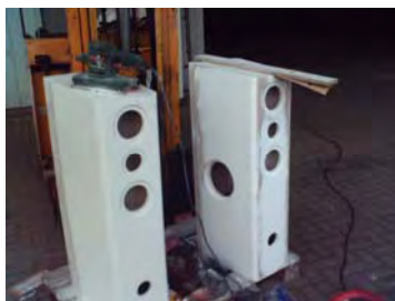
dritte Grundierung und 3 Wochen schleifen später
