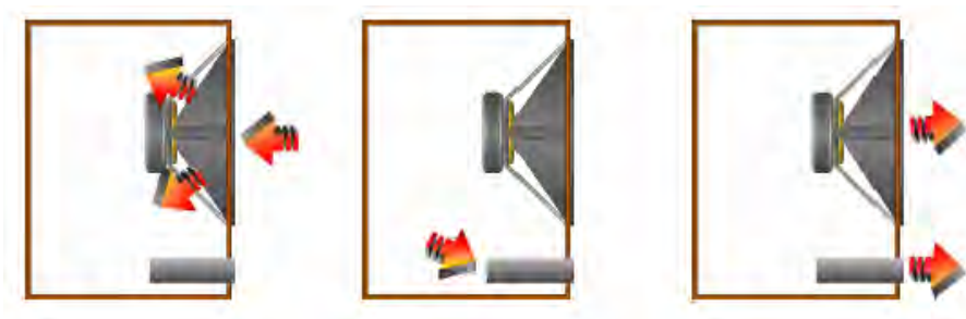
Abb. 12 Bassreflexsystem im Fall c
